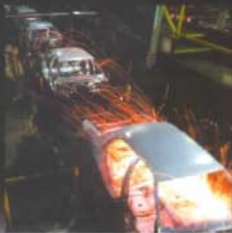
Rôbốt lắp ghép các bộ phận của xe hơi lại với nhau với chiếc đèn hàn.
